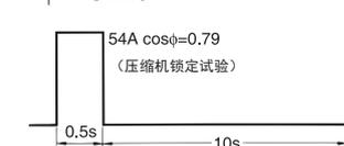
• 线圈施加电压 额定值的100%
