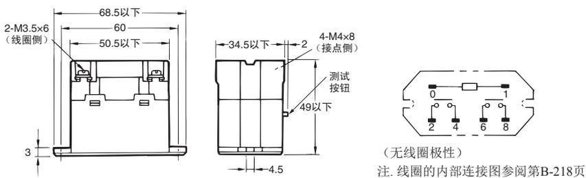
●印刷基板安装型
