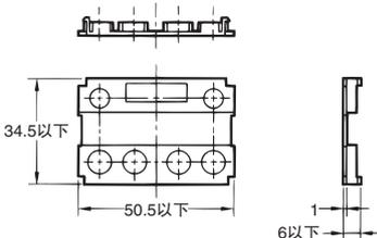
通过护罩保护端子充电部位, 防止接触导致的触电。
